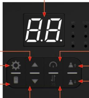
**Kurzes Drücken:** Anzeige des aktuellen Parameters der Toröffnungsgeschwindigkeit: **AD** (Standard)
