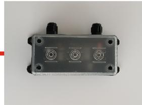
Box mit Funksender für Anschluss für Sicherheitselemente
