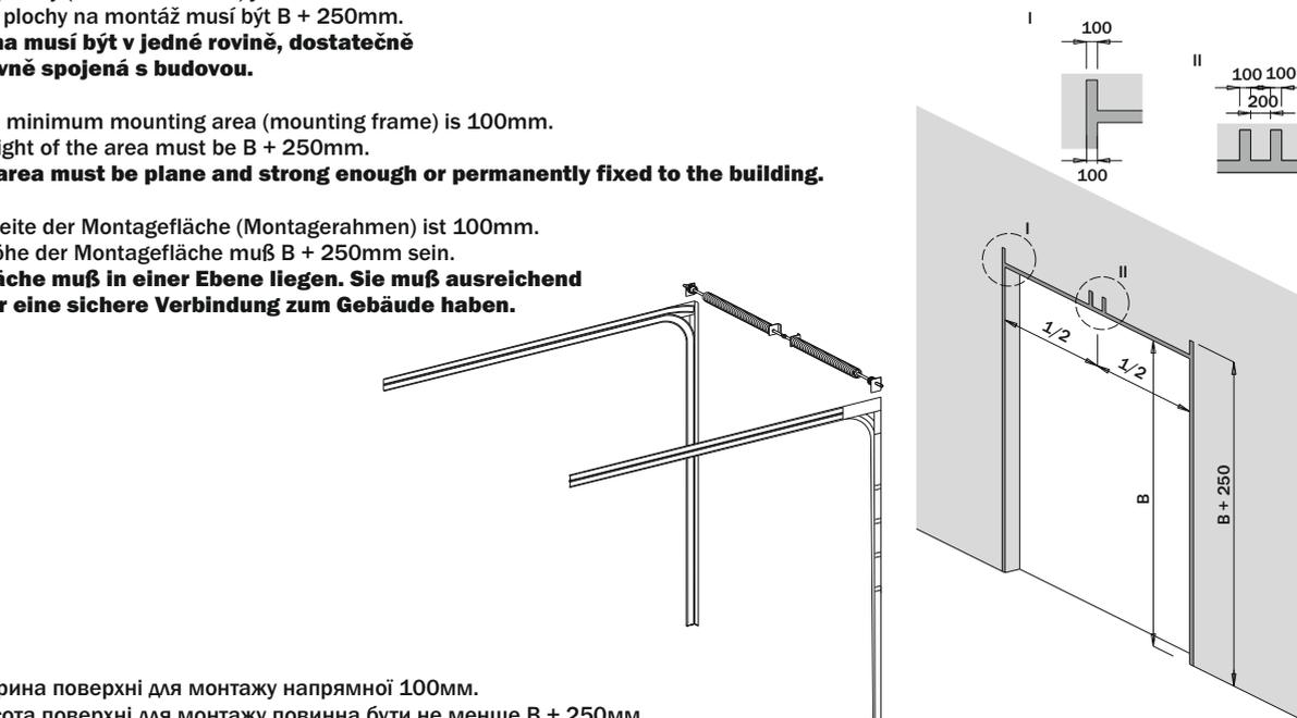
**CZ** Varianta pro montáž 4 pružin (od šířky vrat 4 251mm)
