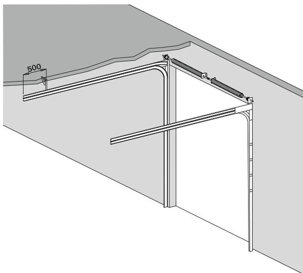
**CZ** Od plochy otvoru 12m<sup>2</sup> je potřeba dvou horizontálních ukotvení u každé kolejnice.
