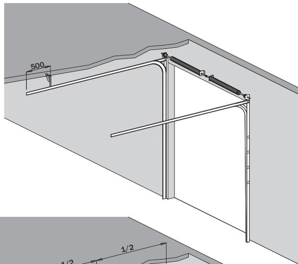
**CZ** Nad výšku vrat 3 510mm nebo plochy vrat větší jak 12 do 20m<sup>2</sup>, je potřeba min. dvou horizontálních ukotvení u každé kolejnice.
