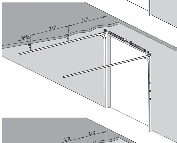
**CZ** Nad výšku vrat 4 000mm nebo plochy vrat větší jak 20m<sup>2</sup>, je potřeba min. tři horizontálních ukotvení u každé kolejnice.
